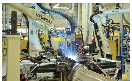
1 울산 북구 효자로에 위치한 세종공업 사옥 2 세종공업 공장은 대부분 자동화 설비가 갖춰져 있어 직원들은 기기 작동과 관리를 담당한다. 3 배기시스템 부품을 만들고 있는 산업로봇
